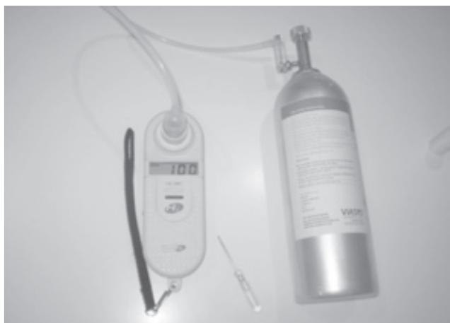
**Мал. 5.** Портативний електрохімічний аналізатор концентрації водню в повітрі. Апарат щойно відкалібрований
