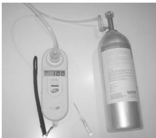
Рис. 1. Портативный электрохимический анализатор концентрации водорода в воздухе. Аппарат только что откалиброван
