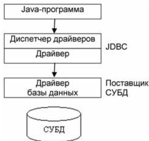
Рис. 1. Схема підключення Java-програми до бази даних
