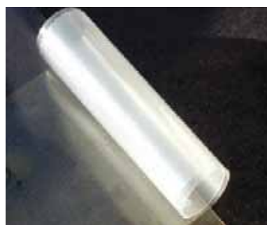
Рис. 3. Схема определения степени полной скручиваемости («свиткообразность») ГУМ по методике компании BASF
