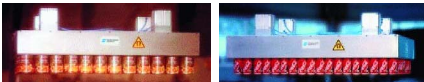
Рис. 3. Магнітний захоплювальний пристрій для формування і розформування транспортних пакетів із порожніх банок
