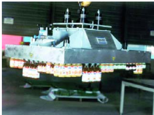
Рис. 5. Магнітний захоплювальний пристрій для формування транспортних пакетів із наповнених скляних пляшок, закупорених жерстяними кришками
