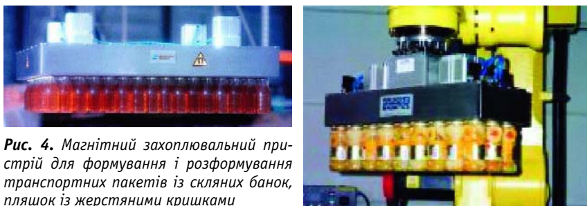
Рис. 3. Магнітний захоплювальний пристрій для формування і розформування транспортних пакетів із порожніх банок
