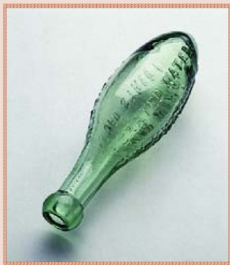
Бутылка для газированной воды, сформованная в конце 1890-х гг. на полуавтомате английского изобретателя Говарда Эшли (1841–1914)
