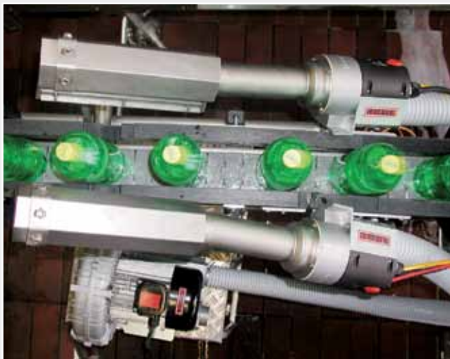
Вид сверху: обдувочные сопла, нагреватели воздуха и вентиляторы.
