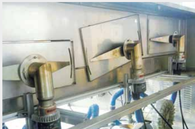
Индивидуальная ориентация широких щелевых насадок Leister на объект усадки
