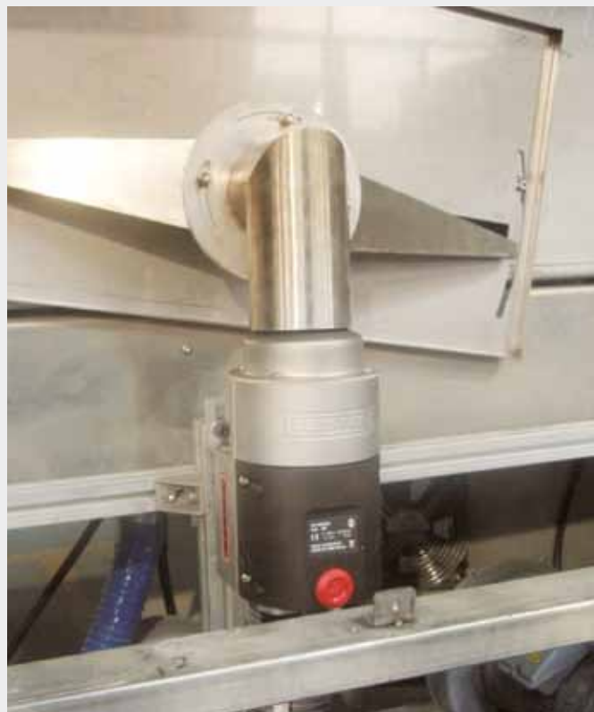
Нагреватель воздуха LHS PREMIUM 60S с широкой щелевой насадкой в испытательной установке
