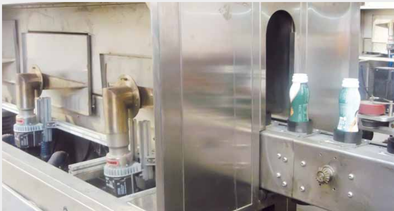
Термотоннель с тремя нагревателями воздуха LE 5000 по обе стороны
