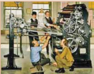
Американский изобретатель Айра Рубел у разработанной им первой трехцилиндровой печатной офсетной машины, которую использовали для нанесения печати на бумажные листы, 1904 г.
