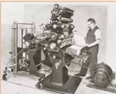
Немецкий инженер Каспар Херманн у сконструированной им листовой офсетной печатной машины для нанесения печати на листы бумаги
