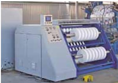
Максимальная ширина разрезаемого рулона 1300 мм, а его максимальный диаметр 1000 мм.
