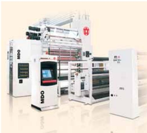
Стало уже обычной практикой улучшать свойства пленки последующим растяжением ее полотна. Наряду с улучшением прозрачности и барьерных свойств такой процесс существенно повышает предел прочности пленки на разрыв. Это играет большую роль для упаковывания сминаемой продукции, такой как минеральная вата или гигиенические товары, например детские подгузники. Со своей технологией MDO W&H предлагает конкретные решения!
