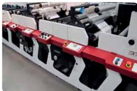
В новой конструкции QCDC секция высечки была развернута на 90°, таким образом, пресс-формы теперь загружаются сбоку, а не сверху. Тракт протяжки роля также был упрощен, что позволяет выполнять сложные работы на высоких скоростях.
