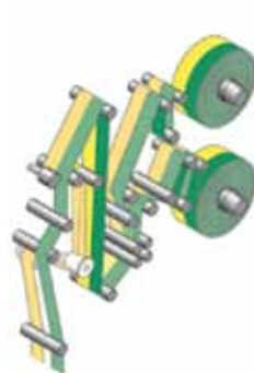
Рис. 6. Технологическая схема универсальной оберточной машины-автомата, которая перенастраивается под упаковку типа Fold wrap (single point underfold), Double-point end fold и Envelope Fold
