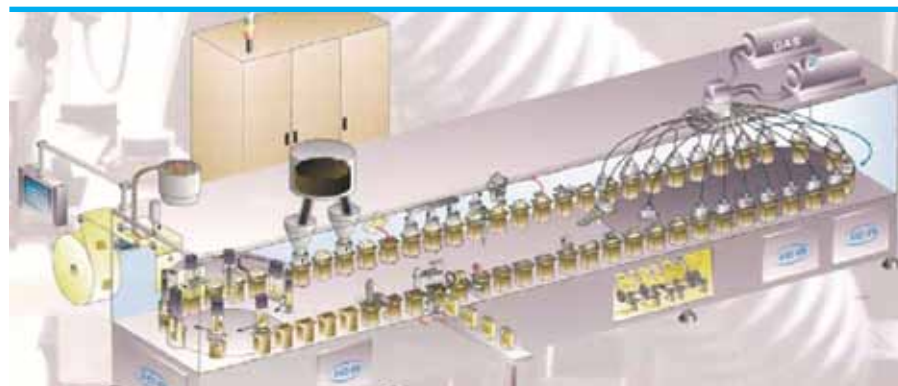
Рис. 9. Компонированная схема горизонтальной роторно-конвейерной упаковочной линии дискретного действия для вакуумного упаковывания кофе в пакеты
