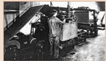
*Немецкий агрегат 1920-х гг. для производства трехслойного гофрокартона*
