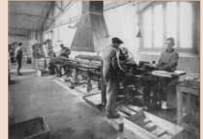
*Автоматическая линия пайки корпусов консервных банок. Франция, 1925 г.*
