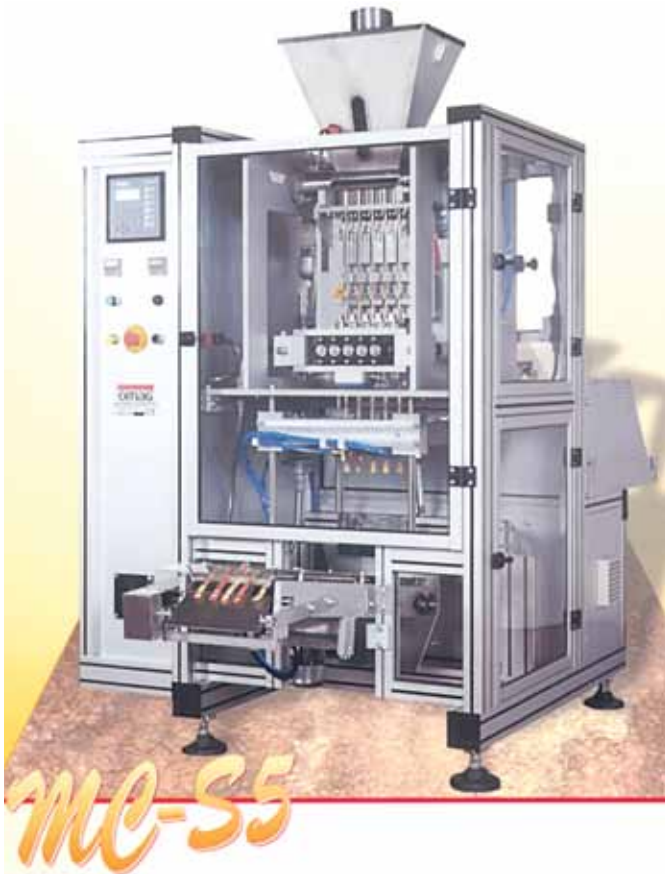
Рис. 2. Машина фирмы Оттаг (Италия) для упаковывания сыпучей пищевой продукции в упаковку типа «стик»
