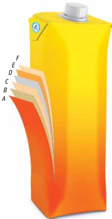
Рис. 1. Структура багатошарового матеріалу на основі картону асептичної упаковки Tetra Pak
