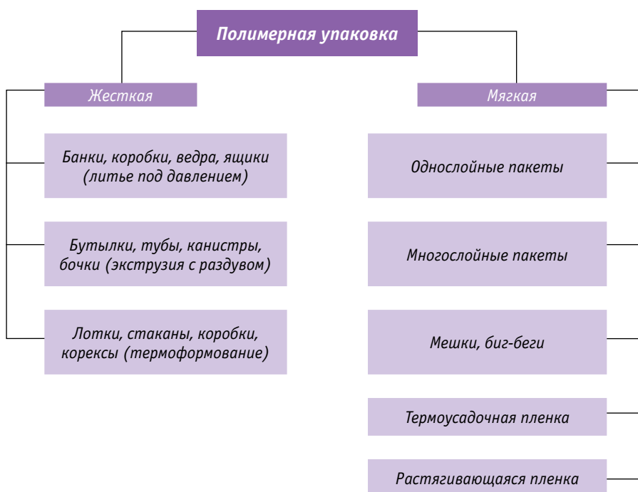
Рис. 1. Структура полимерной упаковки
