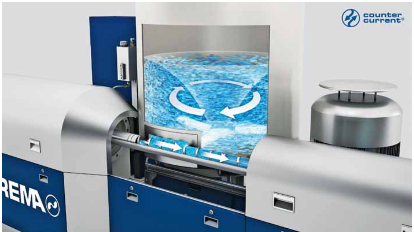
Рис. 2. Схема работы инновационной системы Counter Current
