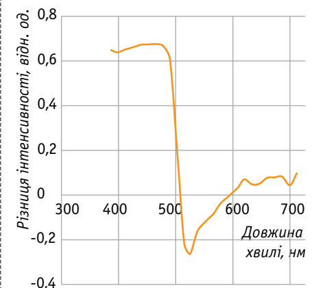
Рис. 2. Різниця спектрів флуоресценції та дифузного відбиття квантових точок QDLight розміром 6,5 нм
