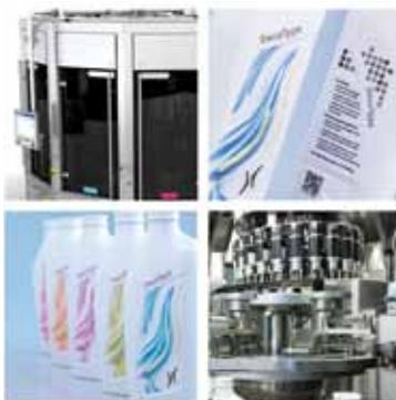
Система DecoType печатает УФ-чернилами размером до 200 мм. Машина имеет модульную конструкцию и компактный дизайн. Она способна наносить печать на пустую полимерную тару из ПЭТФ, ПП и ПЭ. Это могут быть обыкновенные цилиндрические бутылки или тара особой формы. В настоящее время разрабатываются варианты для печати по стеклу и металлу.
