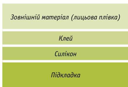
Рис. 1. Структура багатошарового матеріалу для самоклеючих етикеток
