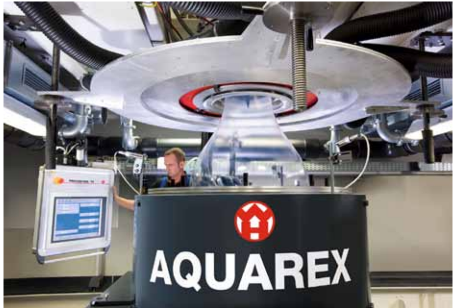
При экструзии с водяным охлаждением пленки имеют особенно хорошие оптические и механические свойства
