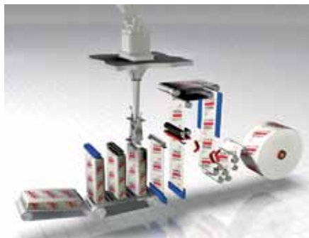
Рис. 3. Вертикальный процесс ФФЗ
