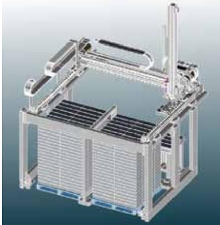
**Рис. 7.** Пакетоформирующая машина на базе портального X-Y-Z-манипулятора с работой на два поддона
