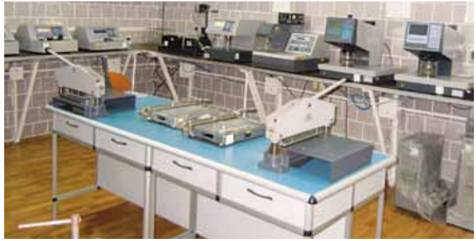
Рис. 2. Приборы для определения физико-механических показателей картона
