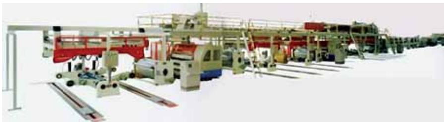
Рис. 2. Гофроагрегат для производства МГК
