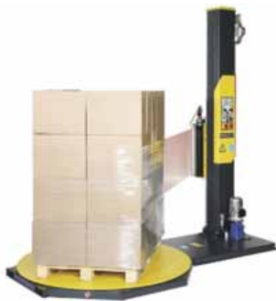
Рис. 4. Машина для скріплення транспортних пакетів розтягувальною плівкою за принципом спірального навивання
