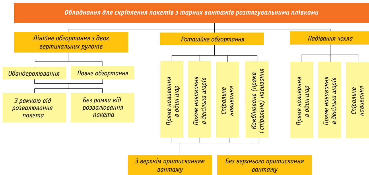
Рис. 2. Класифікація обладнання для скріплення пакетів розтягувальною плівкою
