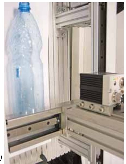
Рис. 3. Сканування універсального коду у статичному (а) та динамічному (б) режимах роботи системи
