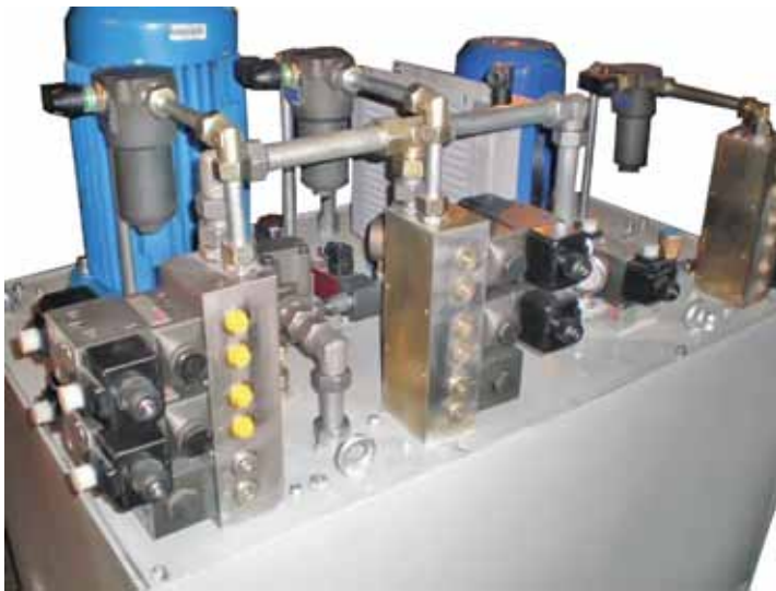
Рис. 5. Общий вид объемного гидрпривода с устройствами управления
