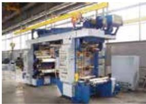
В мае 2016 г. АО «Киевполиграф-маш» завершило производство и поставило заказчику флексопечатную машину ФДР-850М в комплекте с установкой для монтажа печатных форм УМФ-850. Машина изготовлена по индивидуальному заказу фирмы «Фуд Центр» (г. Сумы).
