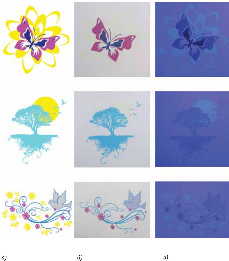
Рис. 8. Приклади комбінованих зображень, надрукованих традиційними фарбами і фарбами з нанофотонними елементами: оригінал-макет (а), зображення при денному світлі (б), зображення при УФ світлі (в)
