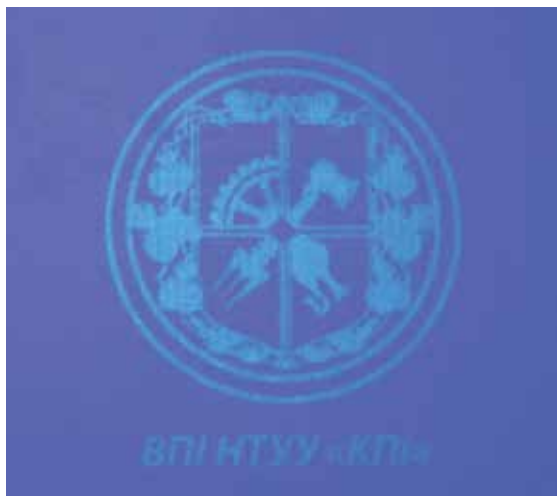
Рис. 7. Вигляд невидимого при денному світлі зображення, надрукованого фарбами з нанофотонними елементами, у процесі опромінення УФ світлом
