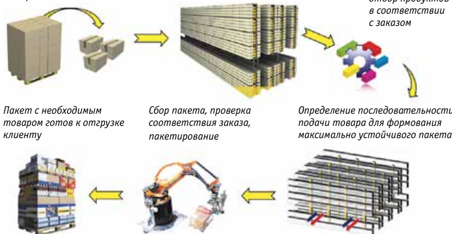
Рис. 1. Схема работы систем SCP и STS
