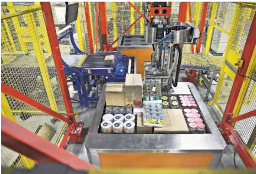
Рис. 3. Робот для формирования пакетов
