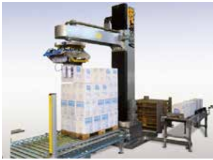
Рис. 2. Автоматизований чотиривісний робот для формування транспортних пакетів
