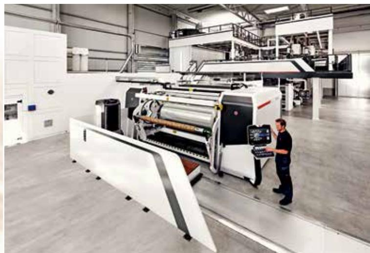
Компания **Windmöller & Hölscher** представила экструзионную установку нового поколения Filmex II для получения барьерных и стретч-пленок из полипропилена и других полимеров плоскощелевым способом.
