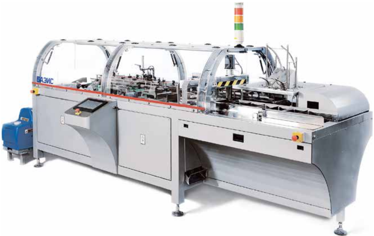
Рис. 2. Типичная горизонтальная упаковочная машина-картонатор: общий вид (а); схема обработки пачки (б)
