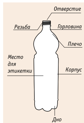
Рис. 2. Основные элементы полимерной бутылки
