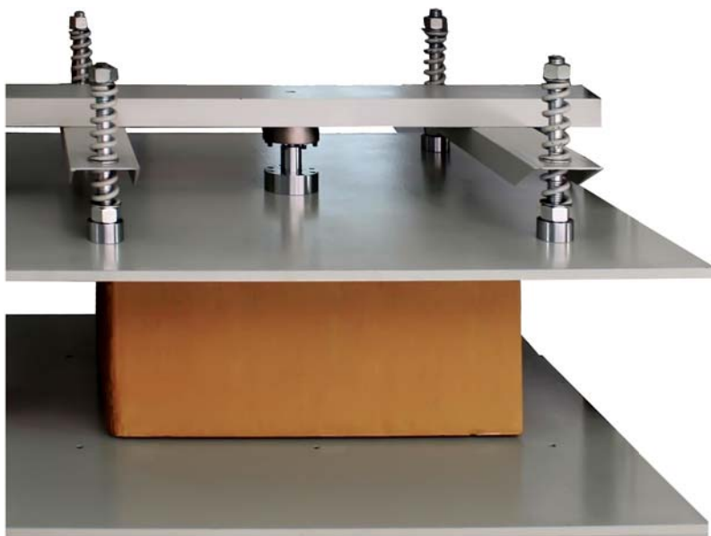
Рис. 1. Пристрій для визначення стійкості до навантаження при штабелюванні картонної упаковки
