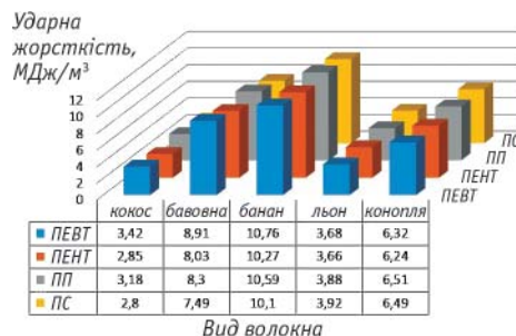
Рис. 1. Залежність ударної жорсткості ( U_v , МДж/м 3 ) полімерних композиційних матеріалів від типу матриці і волокна з об'ємною часткою 40%
