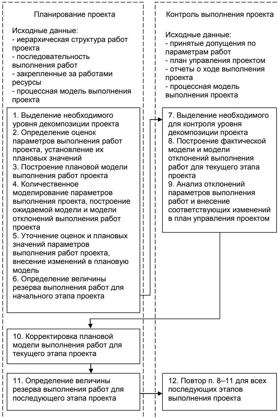
Рис. 1. Системное моделирование параметров работ при планировании и контроле выполнения проекта
