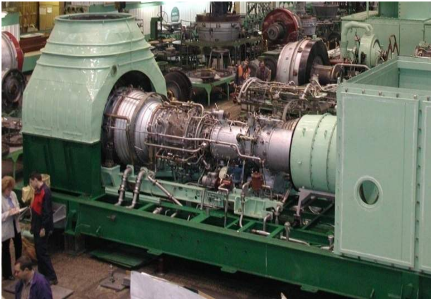
Рис. 3. Модернизированный турбоблок ГПУ-10-01 с двигателем UGT 10000 (ДН70Л)
