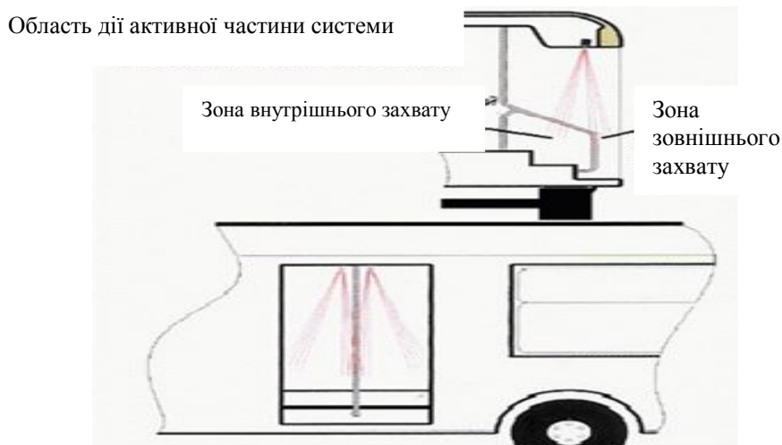
Рис.1. Область дії активної частини системи підрахунку пасажирів за допомогою інфрачервоних датчиків
