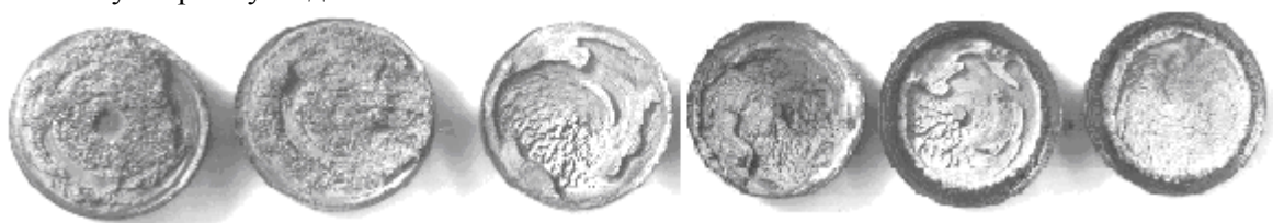
Рис.1. Поверхні руйнування з'єднань сплаву ЖСЗДК із сталлю 40Х після випробувань на розрив
