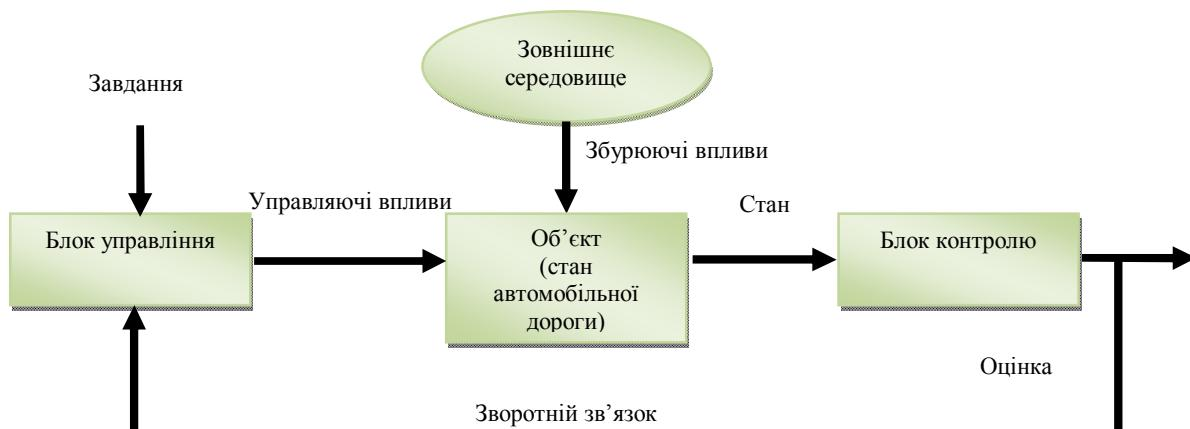
Рисунок 2. - Структурна схема системи управління
