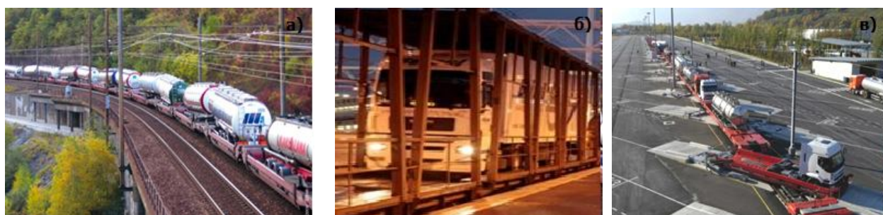
Рисунок 1. – а) «Роллінг шосе» (rolling road); б) Вагон трансфер (car shuttle train); в) термінали системи Modalohr
