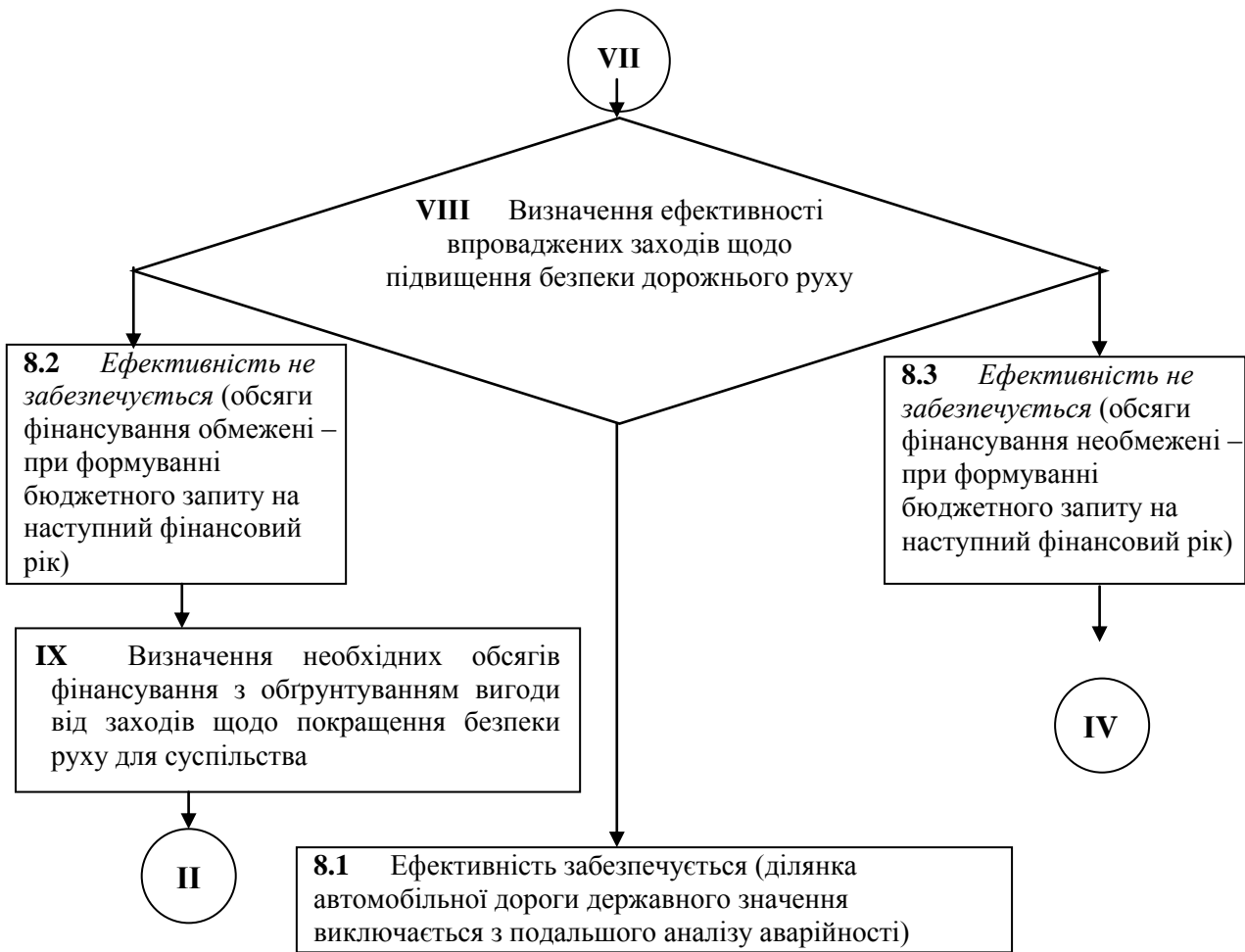
Рисунок 1 – Алгоритм визначення рівнів безпеки руху на автомобільних дорогах загального користування державного значення регіону України
