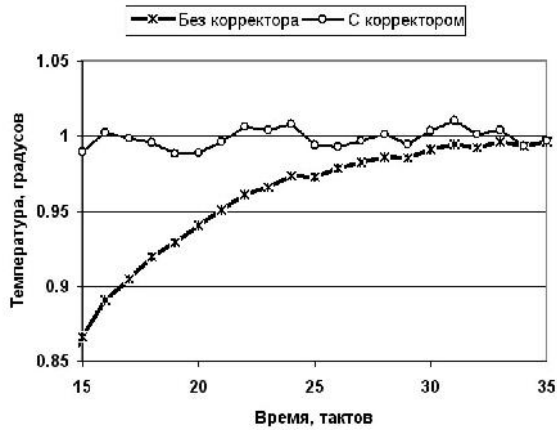
Рис. 4. «Хвост» переходной функции канала измерения с корректором и без него
