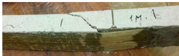
Рисунок 5 – Характер руйнування балки, підсиленої скловолокном (серія №2)
