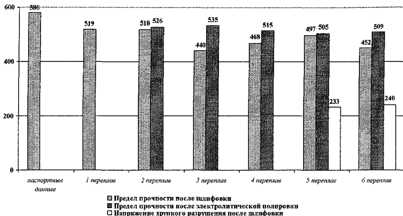
Рис. 2. Предел прочности и напряжение хрупкого разрушения сплава «Remanium CSe» при последовательных переплавах после электролитической полировки поверхностей
