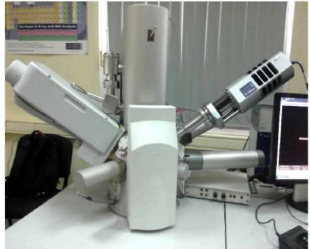
Рис. 1. Загальний вигляд растрового електронного мікроскопа (SEM) "Mira 3 LMU" («Tescan», Чехія) з інтегрованим енергодисперсійним спектрометром «X-max 80mm2» («Oxford Instruments», Великобританія)
